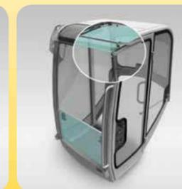
2 El cristal superior se repliega de forma sencilla bajo el techo de la cabina. Allí se mantiene protegido.
